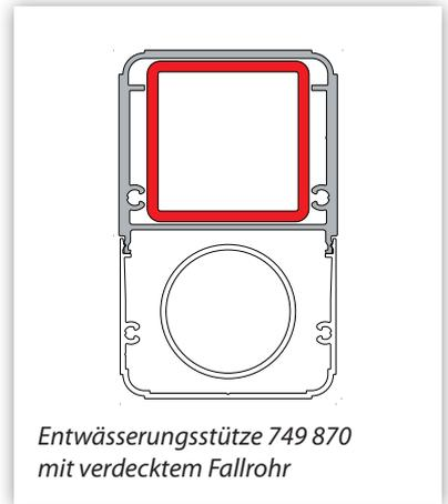
Entwässerungsstütze 749 870 mit verdecktem Fallrohr
